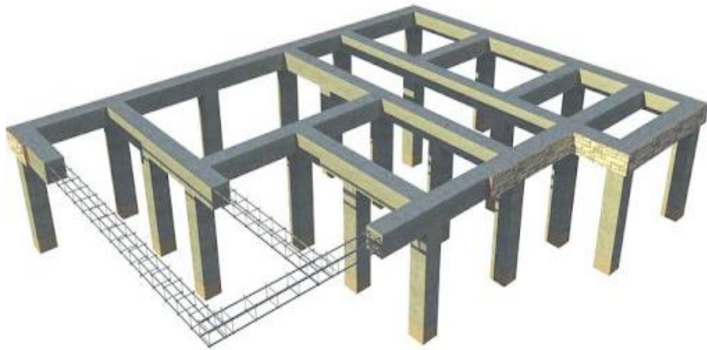
Малюнок 20. Схема свайно-ростверкового фундаменту
