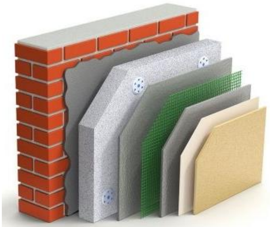
Малюнок 21. Схема пошарової структури стін та огорожувальних конструкцій
