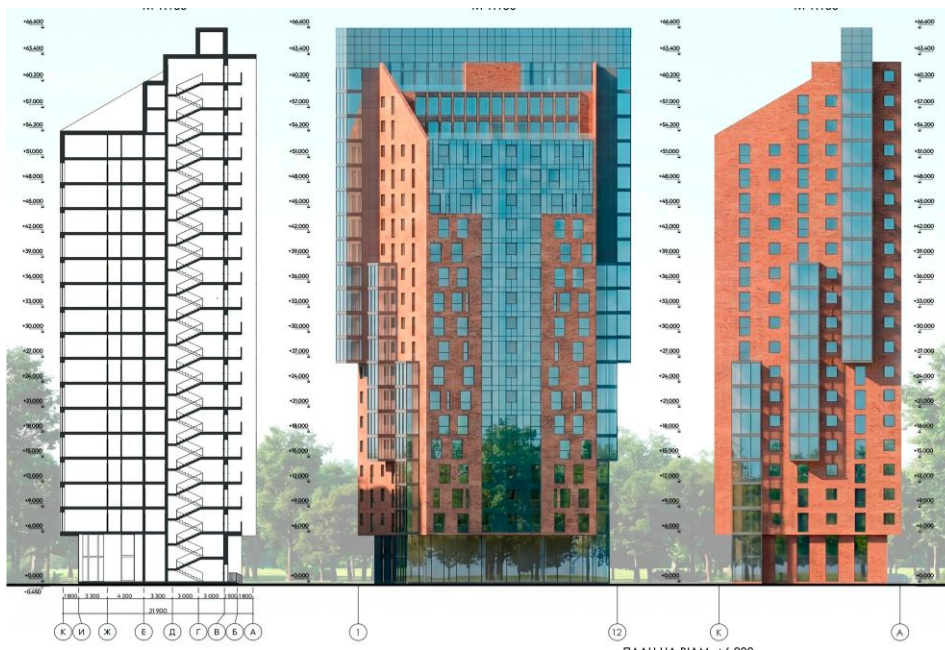
Рисунок 2.6. Розріз та фасади будівлі
